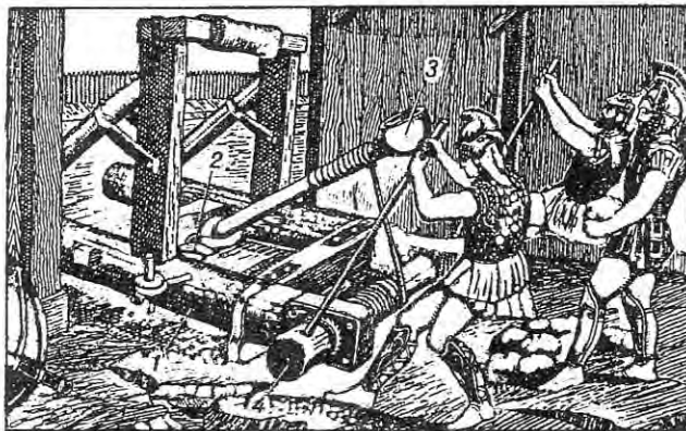
Катапульта; 1 — деревянная рама; 2 — канат из сухожилий; 3 — ложка для бросания камней и др.; 4 — ворот для натягивания каната.
