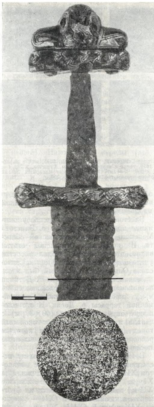
Рис. 6. Меч из Блисовита. Микроструктура лезвия.
